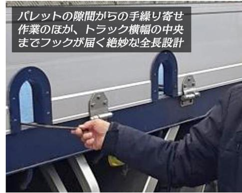
パレットの隙間から手繰り寄せ作業のほか、トラック横幅の中央までフックが届く絶妙な全長設計
